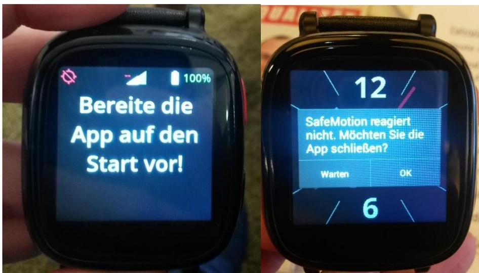
Abbildung 57: Fehleranzeigen des SafeMotion Geräts
